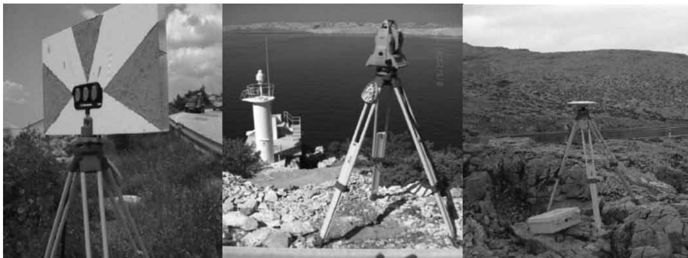
Slika 4: Korišteni instrumentarij za GNSS i trigonometrijski nivelman
