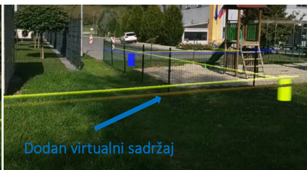
Slika 5: Primjer vizualizacije podzemnog cjevovoda s otvorima
