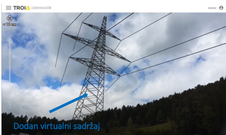
Slika 6: Prikaz vizualizacije nadzemnih vodova u prostoru (buduća trasa visokonaponskog dalekovoda)
